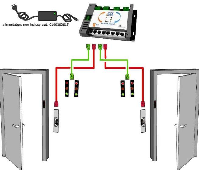
Qui a lato lo schema di connessione per un sistema a due porte. Nel caso di tre e quattro porte si replica il medesimo principio.
